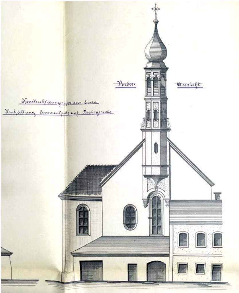
Plan zur Umgestaltung der Südfassade der Kirche mit neobarocken Elementen und der Versetzung des Turms nach den Plänen von Johann Baptist Schott
